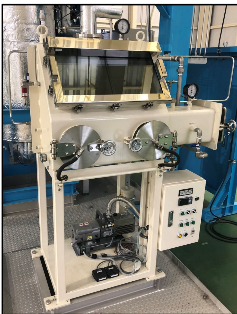
グローブボックス (アルゴン充填下でナトリウムを取扱う)
